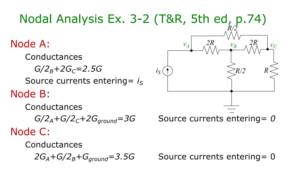
$$\begin{pmatrix} 2.5G & -0.5G & -2G \\ -0.5G & 3G & -0.5G \\ -2G & -0.5G & 3.5G \end{pmatrix} \begin{pmatrix} v_A \\ v_B \\ v_C \end{pmatrix} = \begin{pmatrix} i_S \\ 0 \\ 0 \end{pmatrix}$$
