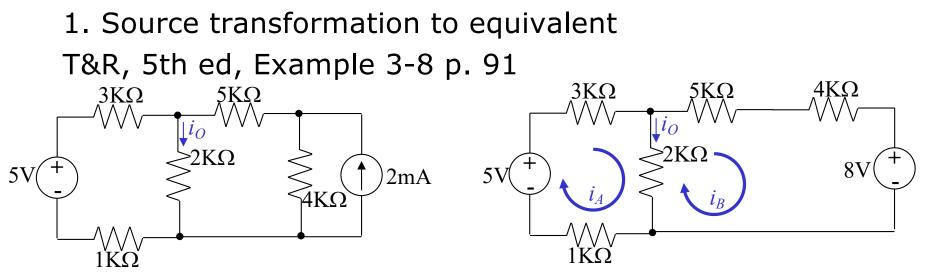
$$\begin{pmatrix} 6000 & -2000 \\ -2000 & 11000 \end{pmatrix} \begin{pmatrix} i_A \\ i_B \end{pmatrix} = \begin{pmatrix} 5 \\ -8 \end{pmatrix}$$
